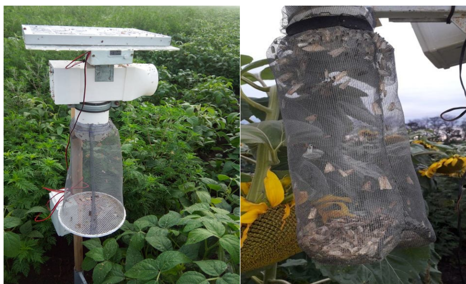
Рисунок 1 – Аспирационная ловушка с сепарирующим насекомоприемником.
