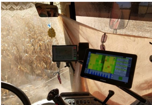
Рисунок 2 - Монитор ТМХ-2050 системы картирования урожайности Trimble YМ, установленный в кабине зерноуборочного комбайна Десна-Полесье GS-12
