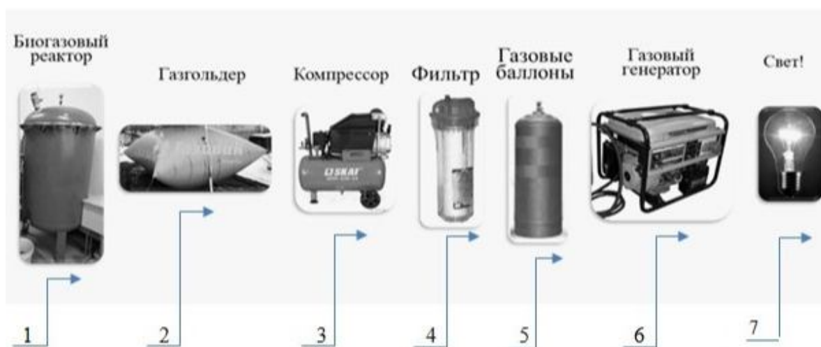
Рисунок 2 – Оборудование, входящее в технологическую линию адаптированной психрофильной технологии: 1 – метантенк объемом 1 м 3 ; 2 – газгольдер; 3 – компрессор; 4 – фильтр; 5 – газовый баллон; 6 – газовый генератор; 7 – электричество
