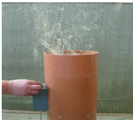
Рисунок 4 – Процесс очистки зерна в сепараторе РМ-228
