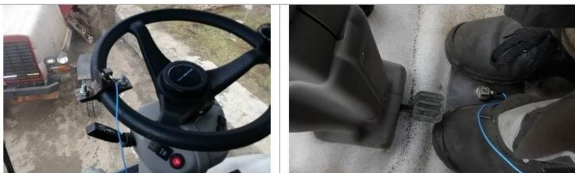
Рисунок 1 - Расположение датчиков вибрации в кабине
