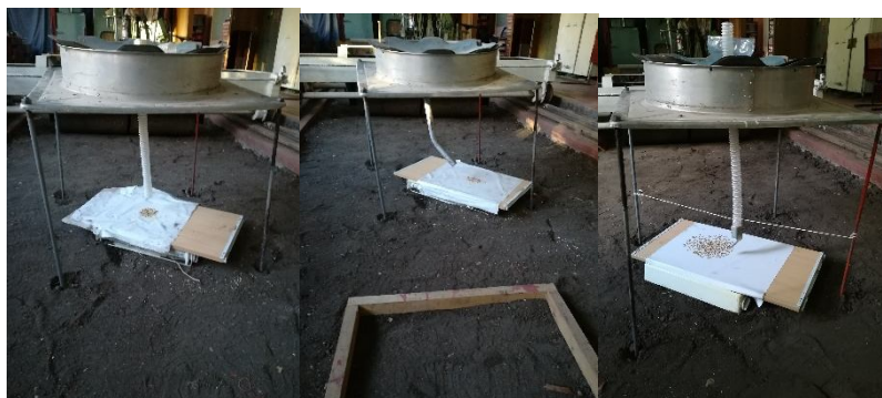
Рисунок 5 - Исследованные семяпроводы на лабораторной установке: а – вертикальный для сеялки Р-4,2; б – с наклонным участком от сеялки Р-4,2; в) вертикальный с дефлектором для сеялки Р-4,2; 1- платформа; 2 – стойки; 3 - воронка для семян; 4-семяпровод; 5 - дефлектор; 6 – клейкий лист
