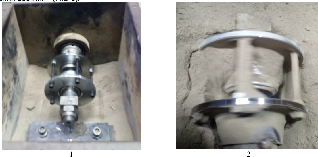
Рисунок 1 – Испытательный стенд герметичности уплотнений (пылевая камера): 1 – общий вид испытываемого подшипникового узла; 2 – увеличенное изображение при работе стенда
